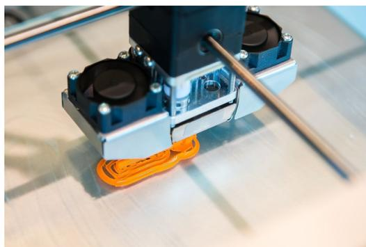
*3D-Druckmaschinen erfordern eine Kühllösung, um eine lange Lebensdauer und optimale Leistung sicherzustellen.*
