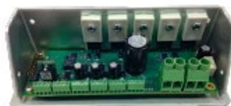
*熱電冷却アセンブリは温度コントローラSR-54シリーズと組み合わると正確な温度制御ができるようになります*
